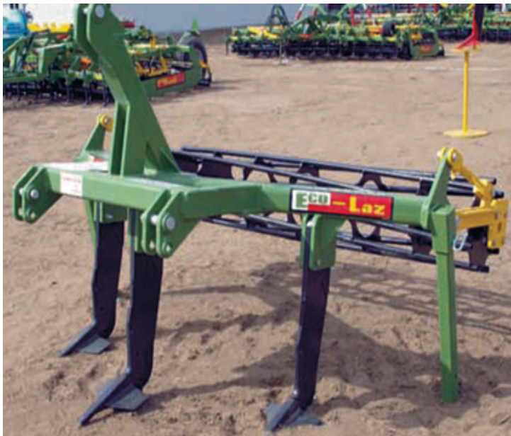
Descriere imagine: Scarificarea solului- Scarificator Ecolaz
